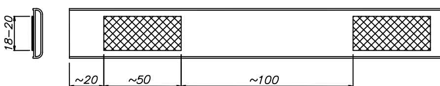
Рис. 16 Наклеивание двухсторонней ленты на декоративную планку
