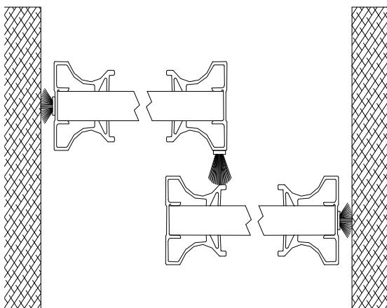
Короткую буферную ленту наклеиваем на боковое углубление вертикального профиля, непосредственно прилегающего к стене или боковой стенке.
