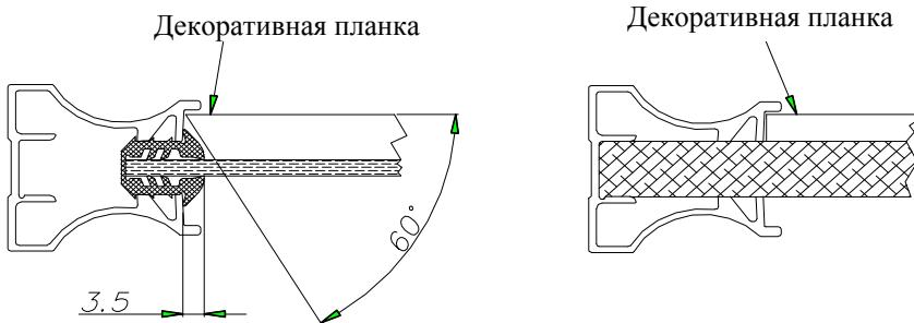
Планка, которая крепится на двери, выполненные из стекла или зеркала должна быть срезана на концах под углом 60°. Делается это потому, что губа прокладки выкладывается на базовой поверхности горизонтального (вертикального) профиля. На дверях, выполненных из плиты, концы планки режутся под простым углом.
