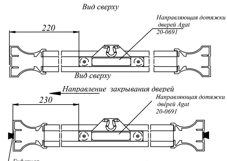
Рис.23 Крепление зацепки к верхнему горизонтальному профилю
