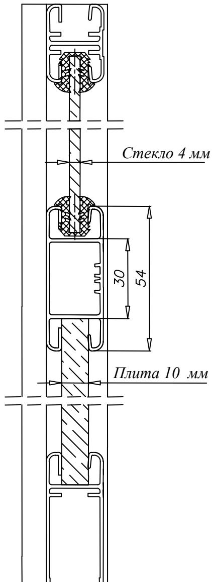
Раскрой дверей системы AL20 ONYX с делительным профилем для монтажа верхней блокировки на определенной высоте.
