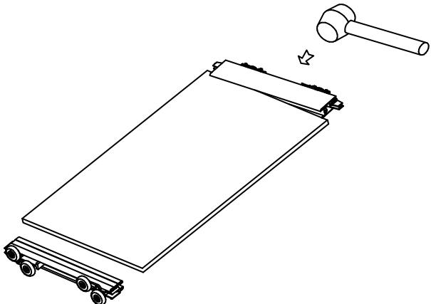
Приложить профиль к углу плиты, а затем прибивать его к плите, применяя резиновый молоток. Положения профиля на плите должно быть центральным, то есть, оба конца профиля должны быть одинаково удалены от концов плиты.
