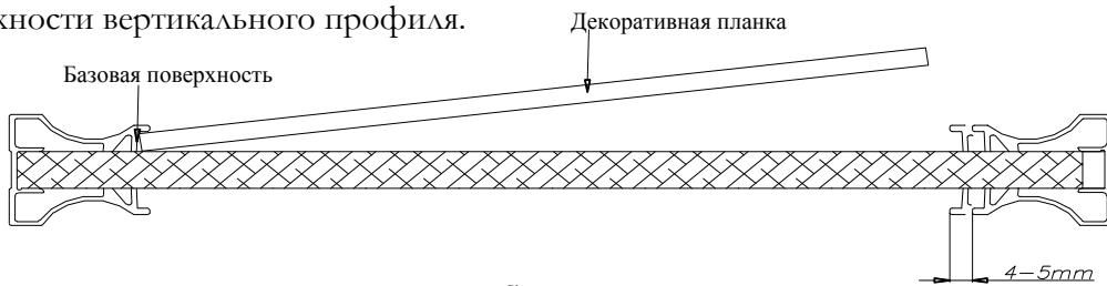
Повыше рисунок представляет способ приклеивания декоративной планки между вертикальными профилями (в горизонтальном или склоненном положении). Чтобы приклеить планку следует с одной стороны окованных дверей ссунуть или отрезать вертикальный профиль на длину около 4-5мм, так чтобы при прикладывании одного конца планки до базовой поверхности, она может быть приклеена. Приклейте у выбранном месте планку , а потом отрезанный профиль повторно подсунуть до края декоративной планки.
