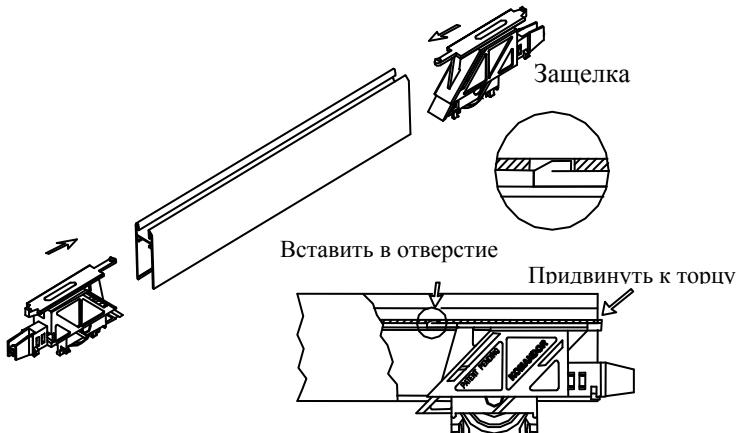
Во время крепления верхних асимметричных роликов к верхнему горизонтальному профилю следует поступать таким же образом, как в случае крепления нижних роликов.
