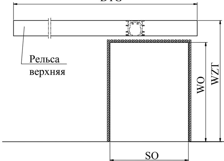
Для расчета размеров должны быть получены наибольшие значения размеров ширины и высоты застраиваемого прохода – SO, также высота крепления верхней рельсы – WZT.
