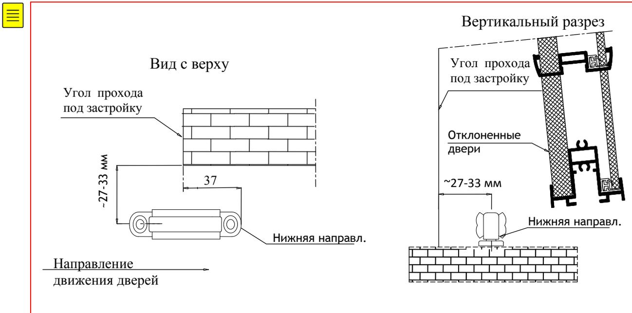
Для крепления направляющей, двери опустить так, чтобы ролик направляющей находился между вертикальными стенками горизонтального профиля.
