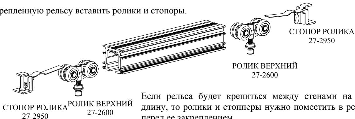
Если рельса будет крепиться между стенами на всю длину, то ролики и стоперы нужно поместить в рельсу перед ее закреплением.
