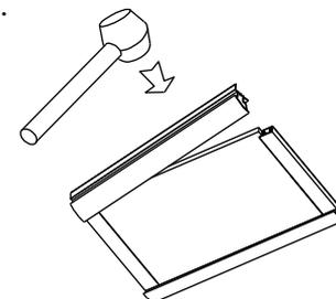
Если в дверях применяются разные виды наполнений или деления, то длина соединяющего профиля, а также входной к нему планки и дистанционной вкладки такая же, как и длина горизонтального профиля. Накладывание вертикального профиля на плиту или стекло происходит таким же способом, как и при монтаже горизонтального профиля. При использовании в качестве наполнения стекла/зеркала также нужно использовать планку и дистанционную вкладку.
