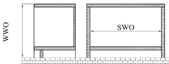
Для расчета размеров двери принимается наименьшее полученное значение ширины застраиваемого отверстия – SWO и высоты отверстия – WWO.
