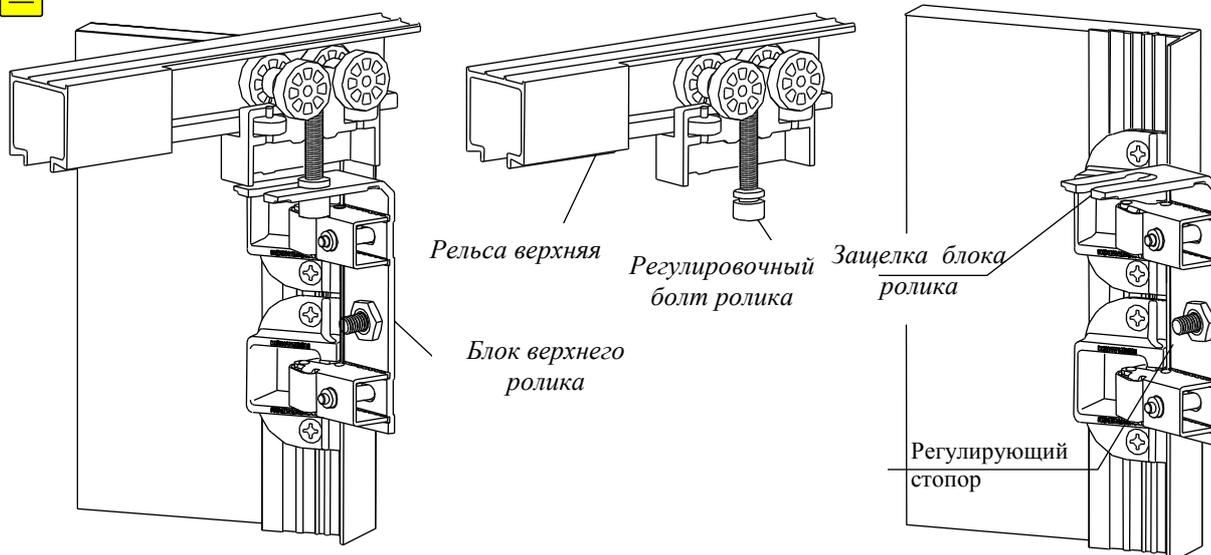
Установить двери под рельсу, и выкрутить (не до конца) регулировочные болты из верхних роликов. Поднять двери так, чтобы вставить колесика блока нижнего ролика в нижнюю рельсу. Затем, установить защелки блока нижнего ролика на головку регулировочного болта нижнего ролика. Повторить эту операцию для противоположной стороны. Вкручивая регулировочный болт регулируется зазор между полом и дверью. **Следует обратить особое внимание на то, чтобы защеп был полностью спрятан в кармане верхнего ролика**
