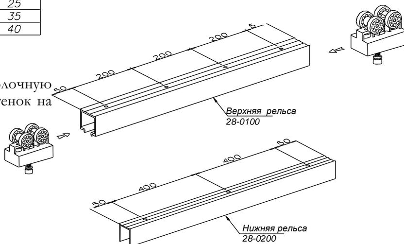
На отверстиях для крепления верхней рельсы сделать фаску 1x45°
