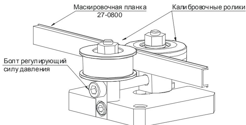
Еще 1 предотвратить выдвигание планки: вручную извлечь конец стержня на длину ок. 2-3 см. Планку нужно вставить в вертикальный профиль со стороны закрепленных верхних роликов, и в конце втиснуть.
