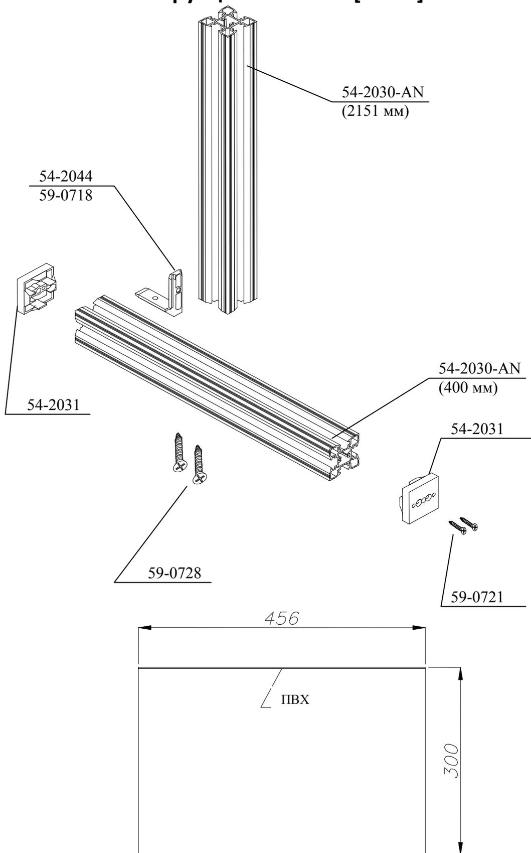
Полки к стенду – 6 шт с плиты 18 мм
