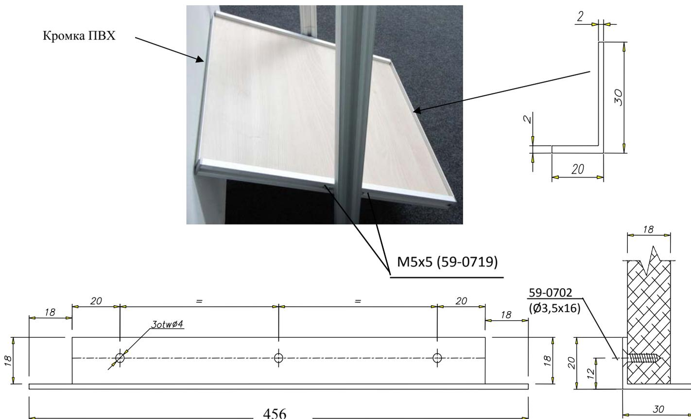
После установки под определенным углом полка прикручивается шурупами M5x5 (59-0719).
