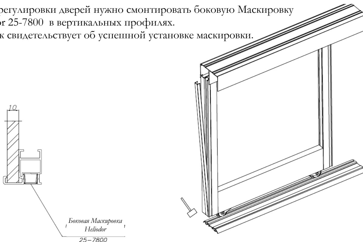
Рис. 21. Монтаж Боковой Маскировки Heliodor 25-7800
