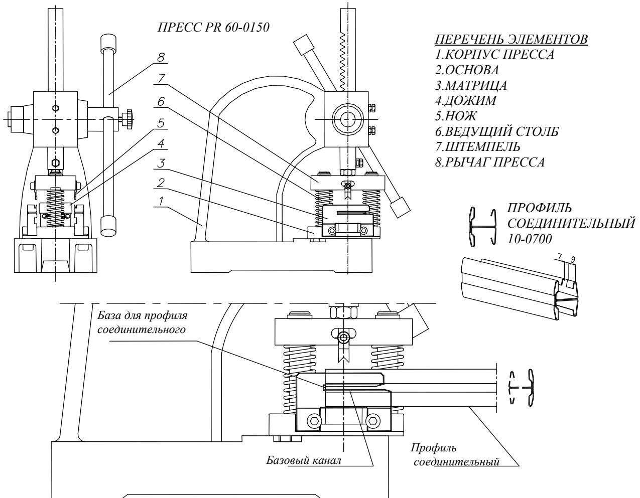
**ПРЕСС УНИВЕРСАЛЬНЫЙ 60-0150** предназначен для вырезания монтажных отверстий в профиле соединительном 10-0700.
