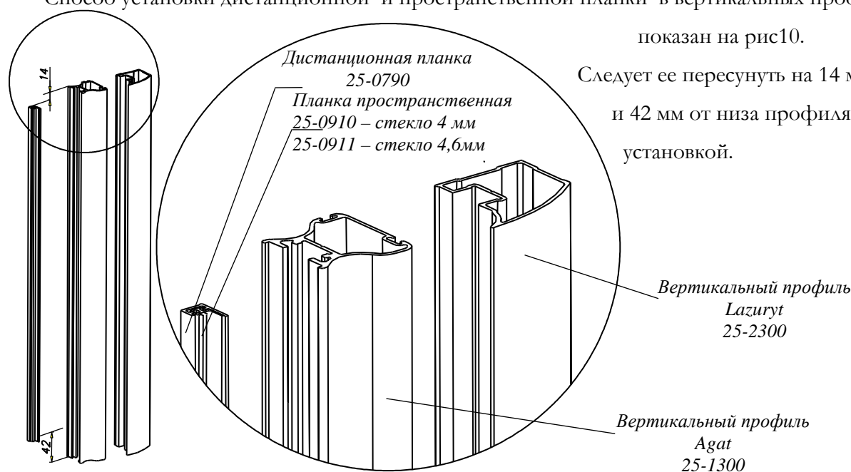
Рис. 10 Монтаж вертикальных профилей перед оковкой стекла
