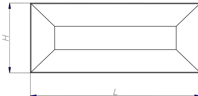
**H** - Высота фасада ящика (минимум 110 мм), **L** - длина фасада ящика. Наполнение ( $H_w$ ,  $L_w$ ) рассчитывается согласно формулам:  $H_w = H - 3$ ;  $L_w = L - 3$ ,
