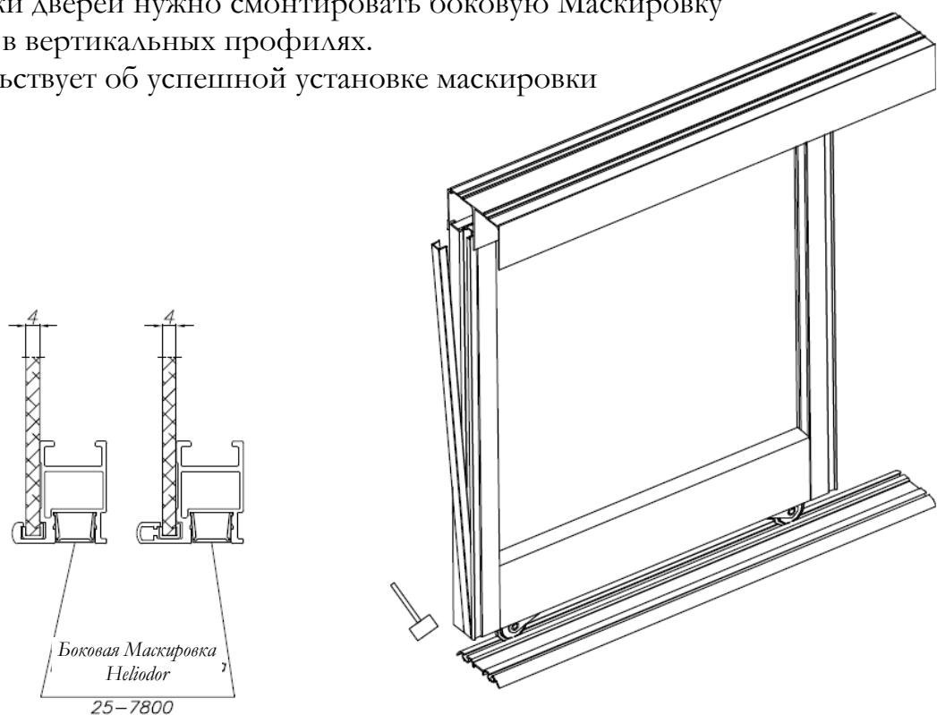
Рис. 18 Монтаж Боковой Маскировки Heliodor 25-7800
