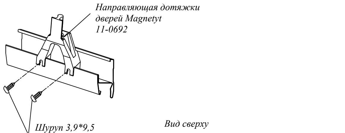
Рис.2а Крепление зацепки к верхнему горизонтальному профилю
