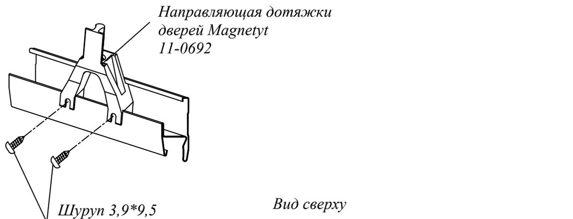
Рис.2а Крепление зацепки к верхнему горизонтальному профилю
