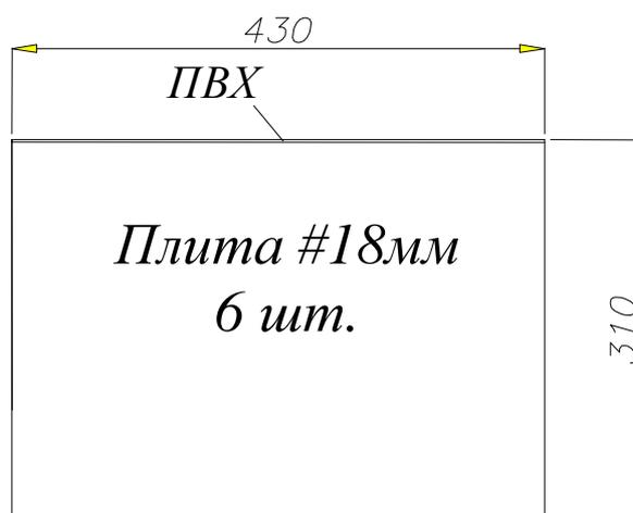
Полки к стенду – 6 шт. из плиты #18мм
