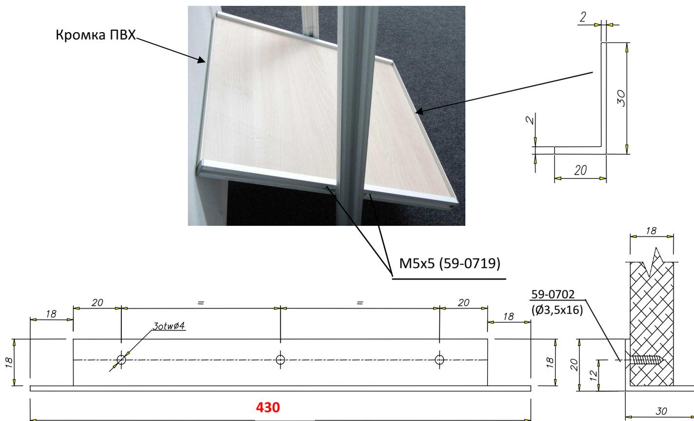
После установки полки под определенным углом нужно ее закрепить, докрутив шурупы М5x5 (59-0719).
