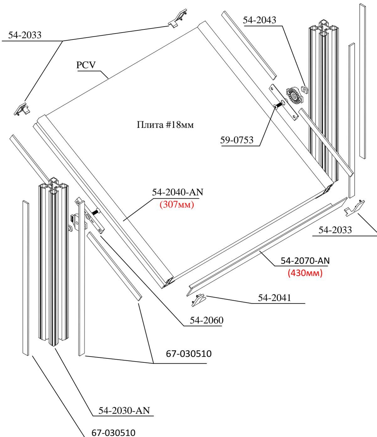
На переднюю часть полки из плиты 18 мм нужно прикрепить алюминиевый профиль – 30x20 со стенкой 2мм (54-2070-AN). Концы профиля нужно сгладить согласно рисунку ниже. Профиль нужно прикрутить к полке при помощи шурупов 59-0702.
