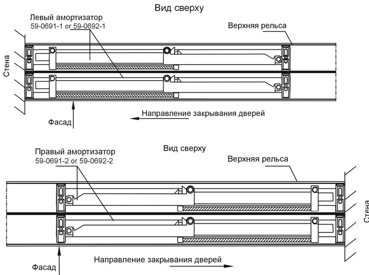
Рисунок 1б Крепление амортизатора к верхней рельсе
