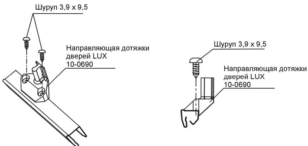
Рисунок.2а Крепление направляющей к верхнему горизонтальному профилю
