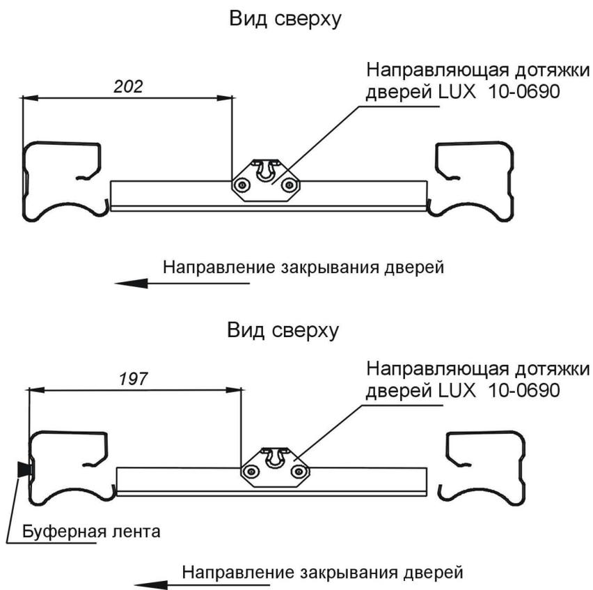
Рисунок.2б Крепление направляющей к верхнему горизонтальному профилю
