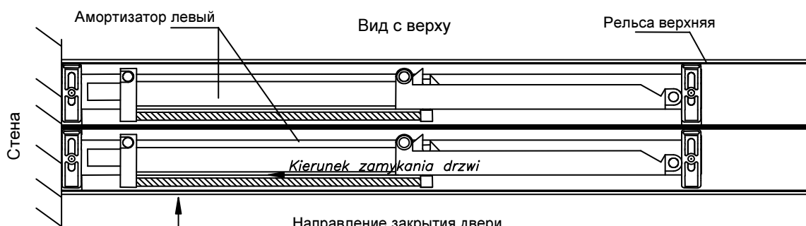
Рис.27 Монтаж газового доводчика в верхнюю рельсу
